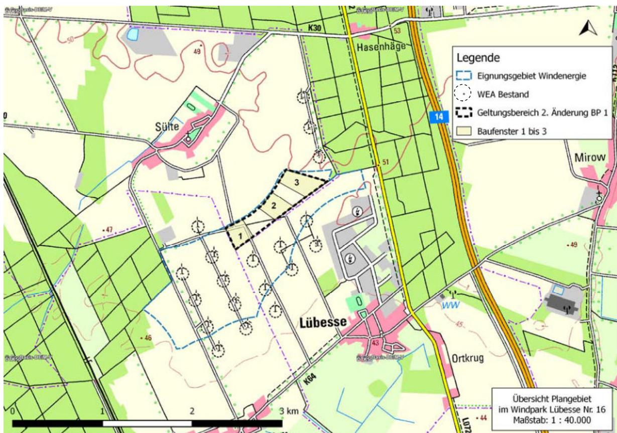
Abb. 1: Übersicht des Plangebiets (Eingegrenzt durch die Grenze des räumlichen Geltungsbereichs des Sondergebietes des BP Sülstorf Nr. 1 mit geplanten Baufenstern 1 bis 3) innerhalb des Windparks Lübesse Nr. 16 (keine Vermessungsgenauigkeit)
